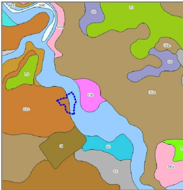
Abb. 6: Übersichts-Bodenkarte M 1:25.000 (Umweltatlas Boden 2019); blaue Strichlinie: Geltungsbereich des Bebauungsplans; braune Fläche: fast ausschließlich Braunerde und Parabraunerde aus kiesführendem Lehm (Deckschicht oder Verwitterungslehm) über tiefem Carbonatkies bis -schluffkies (Schotter); blaue Fläche: fast ausschließlich Kalkpaternia aus Carbonatfeinsand bis -schluff über Carbonatsand bis -kies (Auensediment)
